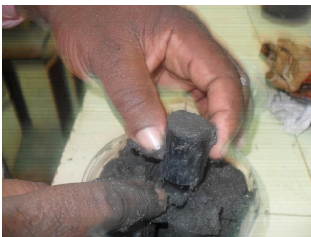
Photo 7: Collecte d'un échantillon de sol au laboratoire pour détermination de la densité apparente
